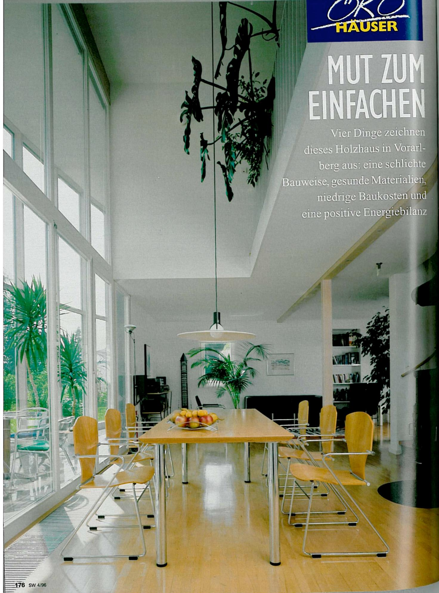
→ Als passive Sonnenfalle funktioniert die Glasfassade im Süden. Leider muß man die Scheiben häufiger putzen, da ein Dachüberstand fehlt. Auf dem flachen Dach des Hauses liegt Kies, auf den Anbauten wächst Gras.
